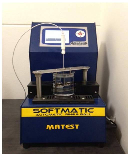
Obrázek 4.16 - Přístroj pro stanovení bodu měknutí KK
