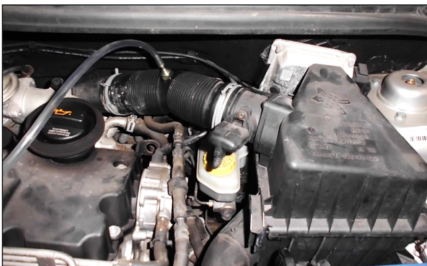
Obrázek 14: Detail připojení výstupu z HHO generátoru do sání motoru za váhou vzduchu (autor)
