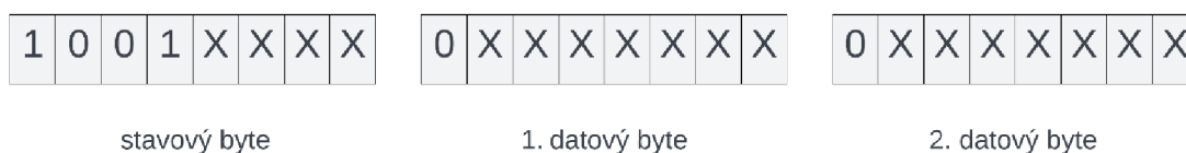
Obrázek 2.2 Grafické znázornění struktury MIDI zprávy Nota zapnuta
