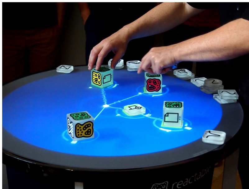
Obrázek 2.7: Hudební systém Reactable využívající TUI. Umisťováním a propojováním jednotlivých kostek na stůl je ovládán syntetizátor, tvořeny nové zvuky nebo zvukové efekty.
