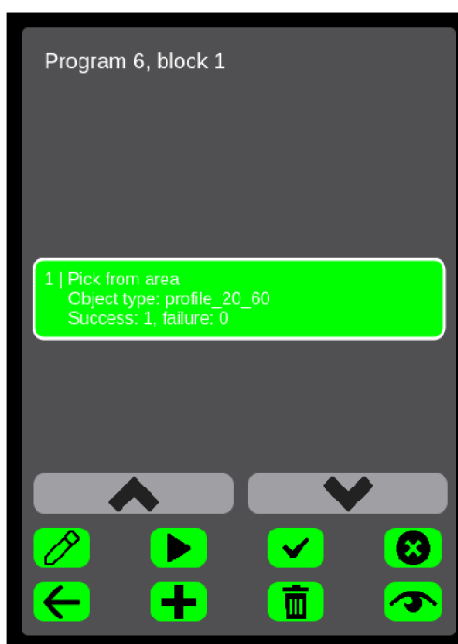
Obrázek 4.5: Výpis instrukcí v bloků rozšířený o možnost přidání, odebrání instrukce, nastavení skoků pro instrukce a vizualizace průběhu programu
