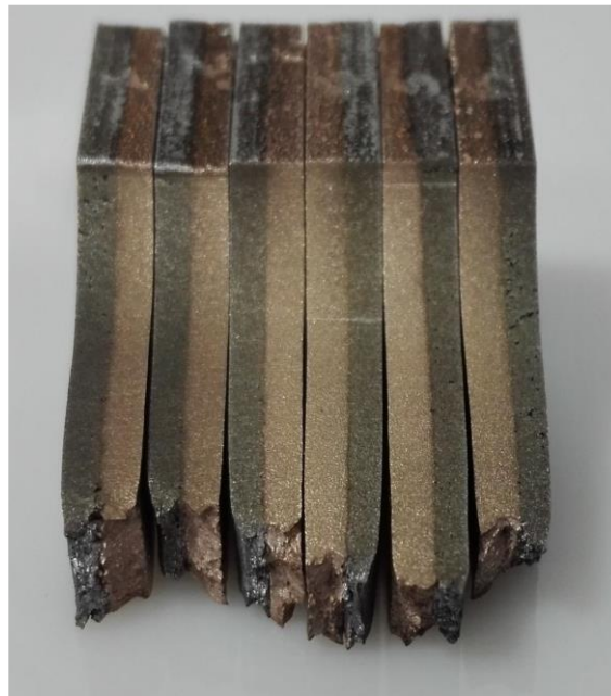
obr 2-7 Lomová plocha tahových těles po materiálovém testování [5]
