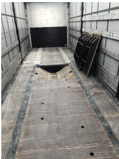
Obrázek 9 Vnitro coilmuldového návěsu
