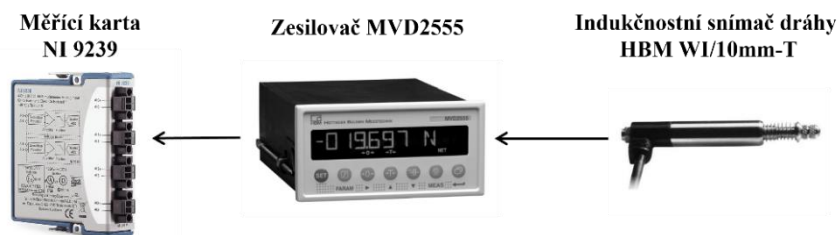
Obrázek 19: Schéma řetězce měření prodloužení [24], [25], [26]
