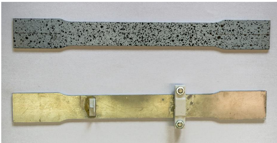
Obrázek 14: Měřený vzorek – skvrnitý vzor, uchycení snímače dráhy
