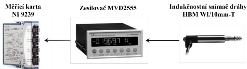
Obrázek 19: Schéma řetězce měření prodloužení [24], [25], [26]
