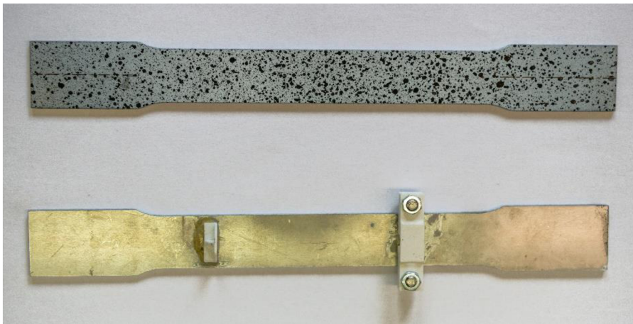
Obrázek 14: Měřený vzorek – skvrnitý vzor, uchycení snímače dráhy
