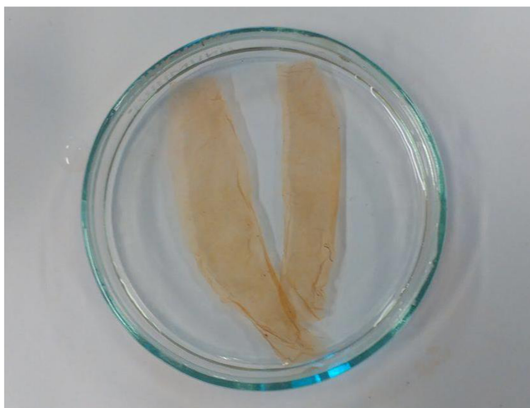
Obr. 24 Pohled na kutikuly izolované chemickou metodou.
