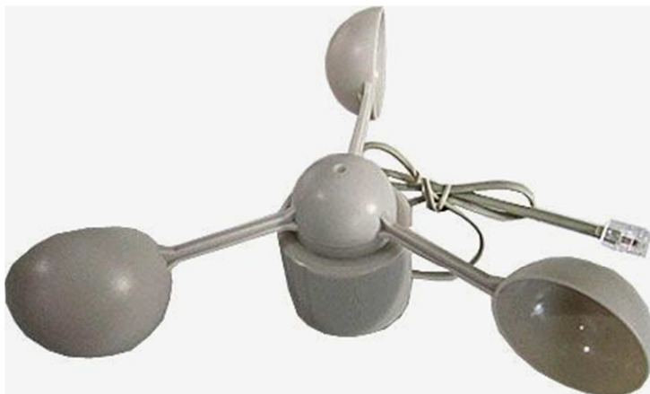
Obr. 5: Miskový anemometr stanice WH1080 T104 [10]
