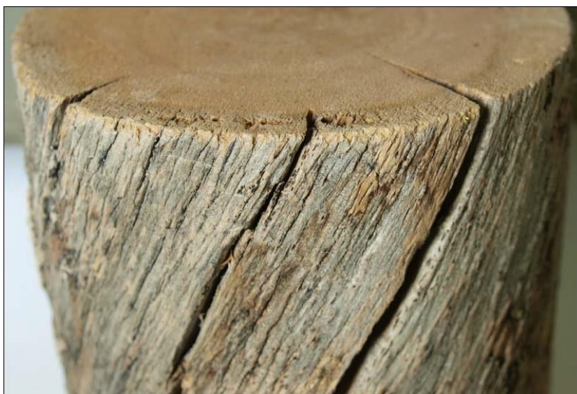
Obrázek č. 4 – točitost / odklon vláken, převzato a upraveno z [20]
