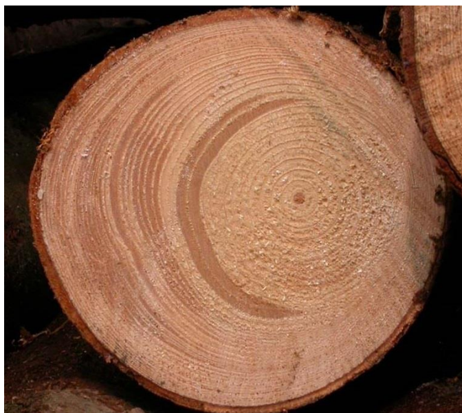
Obrázek č. 7 – reakční dřevo, převzato a upraveno z [20]
