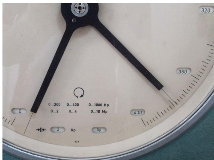
Obrázek č. 28 – výsledná hodnota tahové zkoušky
