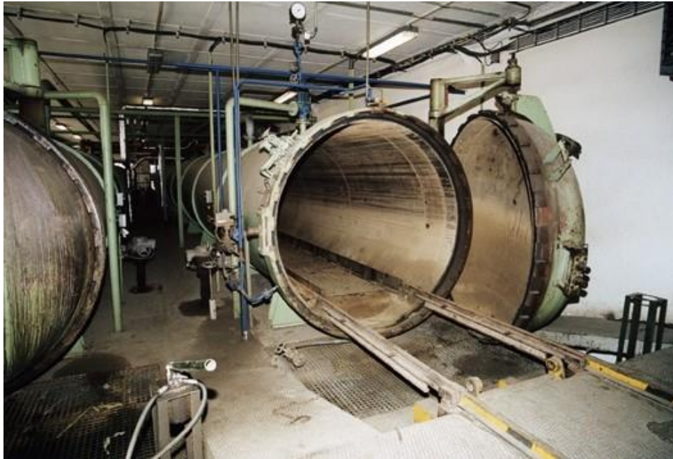
Obrázek č. 54 – impregnační kotel, převzato a upraveno z [23]
