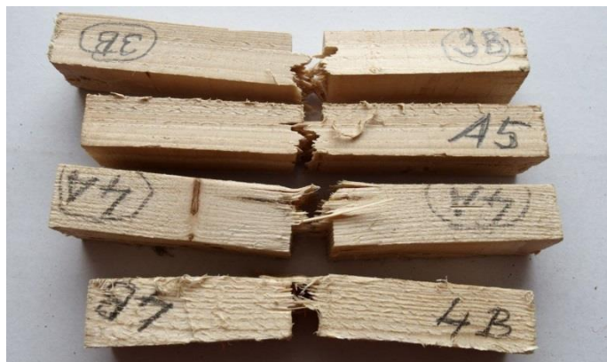
Obrázek č. 45 – přeražené vzorky
