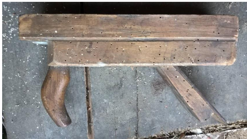
Obrázek č. 17 – hoblík, poškozený červotočem
