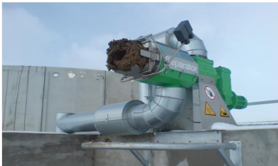
Obrázek 18. – Separátor se šnekovým lisem a sběrnou jámou
