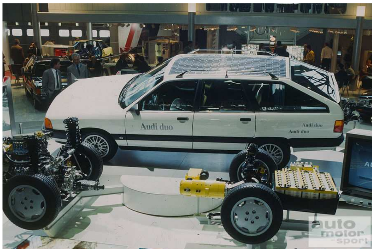
Obr. 9 Podvozek vozu Audi DUO spolu s pohonnými agregáty [10]
