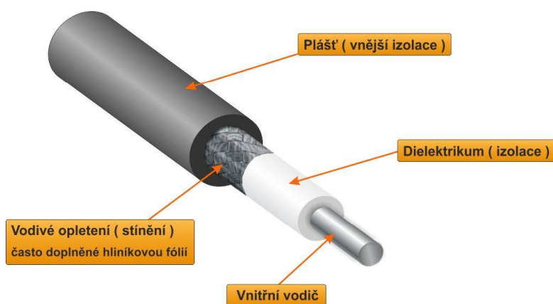
Obrázek č. 6: Řez koaxiálním kabelem
