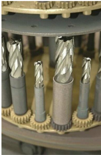
Obr. 11 Nástroje připravené k povlakování upevněné v karuselu zajišťující jejich pohyb. [21]
