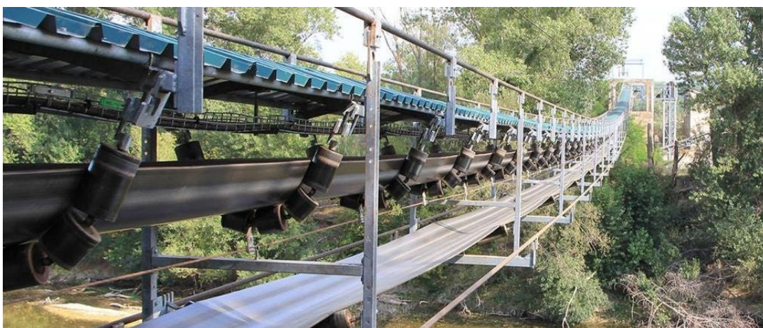
Obr.5: Visutá pásová doprava (Kallista, Pašek 2016)
