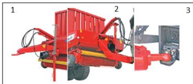
Obrázek č. 2: Agregace s traktorem 1 – agregace do horního závěsu 2,3 – agregace do spodního závěsu (zdroj: http://www.agrowest.com/produkty/senazni-vozy-europrofi )
