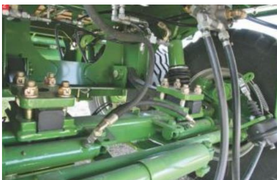
Obrázek č. 16: Neodpružený hydraulický vyrovnávací agregát s náběhovým řízením (zdroj: http://landmaschinen.krone.de/%C4%8Desky/vyrobniprogram/senazni-vozy/sberaci-a-davkovaci-vozy-ax/ )
