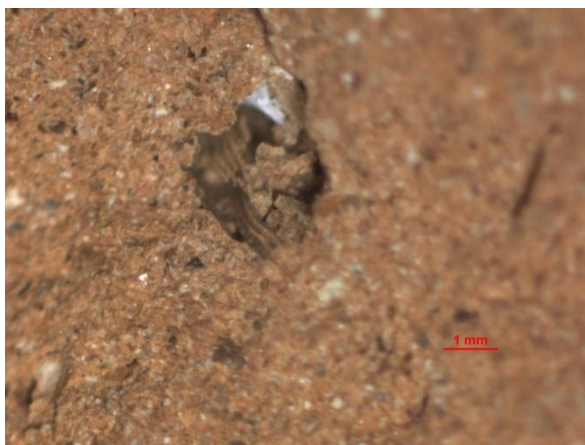
Obr. 21: Detail vyhoření odpadního kordu v cihelném střepe.
