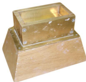
Obr. 14: Forma na výrobu cihlek 100x50x20 mm.
