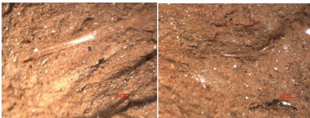
Obr. 16: Detail skleněného vlákna délky 6 mm v cihelném střepu.
