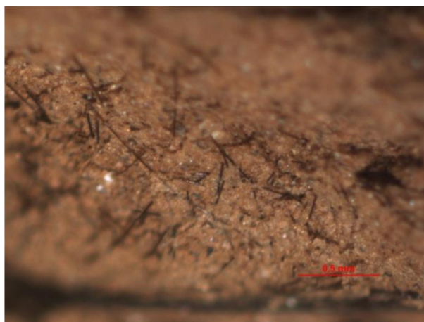
Obr. 19: Detail čedičového vlákna délky 12 mm v cihelném střepu.
