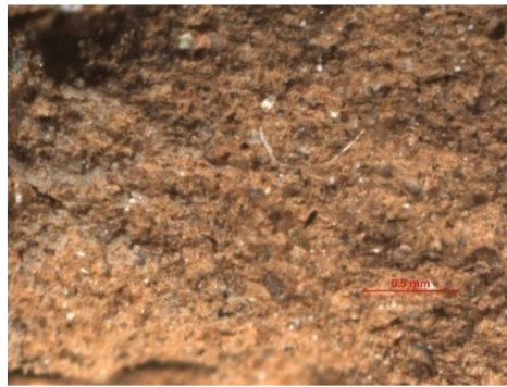
Obr. 15: Detail keramického vlákna v cihelném střepu.
