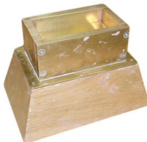
Obr. 14: Forma na výrobu cihel 100x50x20 mm.
