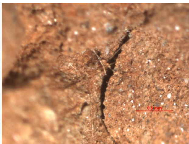
Obr. 17: Detail skleněného vlákna délky 12 mm v cihelném střepu.
