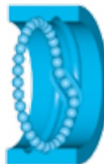
Obrázek 4.7: Převod kuliček deflektorem [13]
