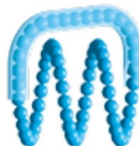
Obrázek 4.9: Převod kuliček v převáděcím kanálu [13]
