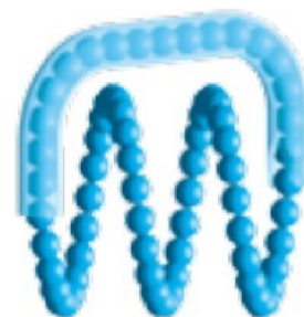
Obrázek 4.9: Převod kuliček v převáděcím kanálu [13]
