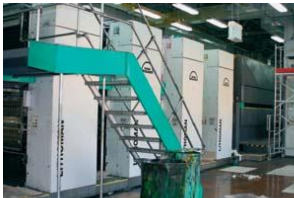
Obrázek 9 Rotační ofsetový stroj Lithoman IV 48
