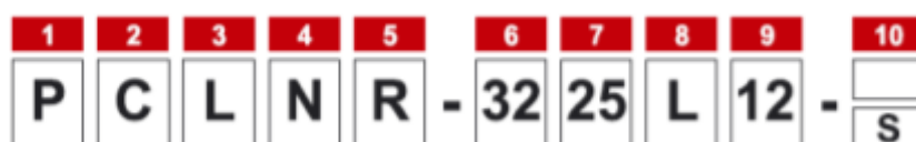
Obr. 26 Značení vnějších soustružnických nožů s VBD dle ISO [35].
