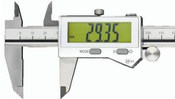
Obr. 13 Digitální posuvné měřidlo s bezdrátovým výstupem dat [17].
