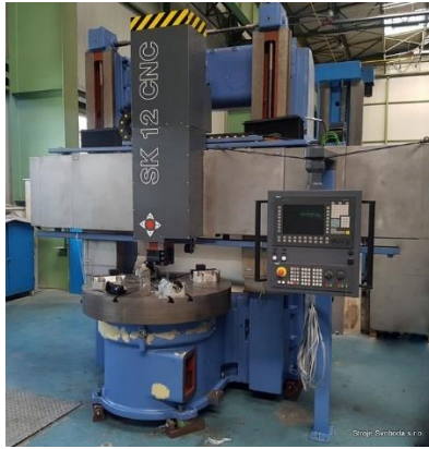
Obr. 20 Soustruh svislý – karusel SK 12 CNC [27].
