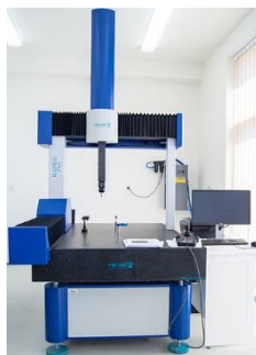
Obr. 12 3D souřadnicový měřicí přístroj [15].
