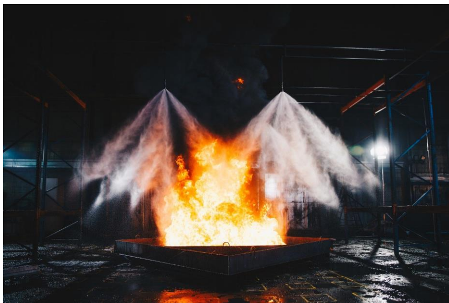
Obrázek 10: Mlhová SHZ - hašení mlhou
