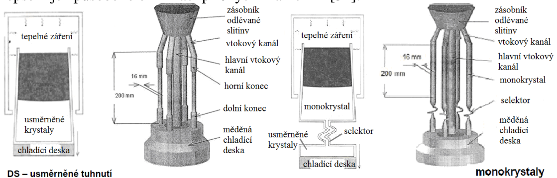
Obr. 4.9 Usměrněné tuhnutí a příprava monokrystalů [27]
