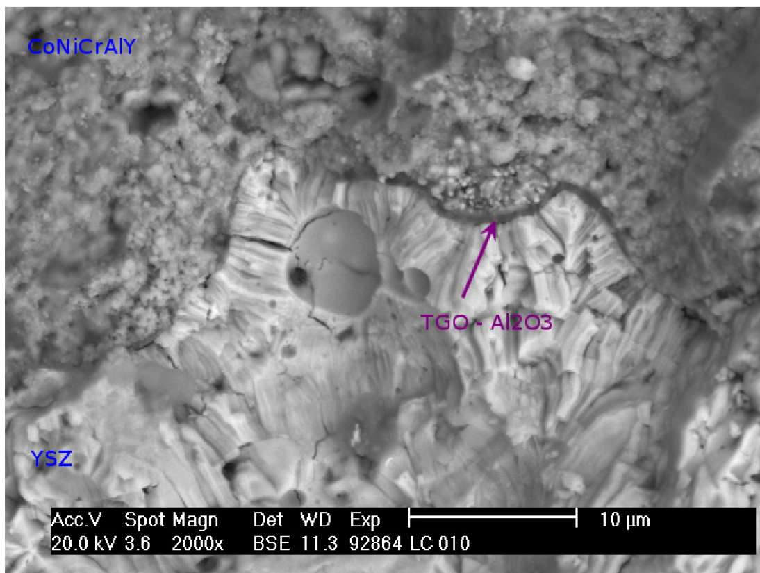
Obr. 9.25 Lomová plocha LC -010, oblast I - TGO na rozhraní YSZ/CoNiCrAlY
