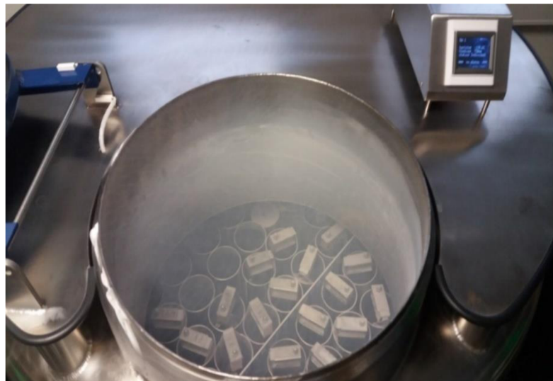
Obr. 13. Skladovací Dewarova nádoba s objemem 240 litrů \text{IN}_2 (Klinika reprodukční medicíny a gynekologie Zlín)
