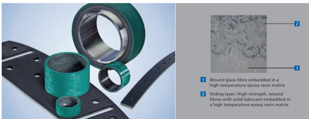
Obr. 2-11 Sklolaminátové ložisko s PTFE klznou vrstvou typu DEVA.TEX [7]
