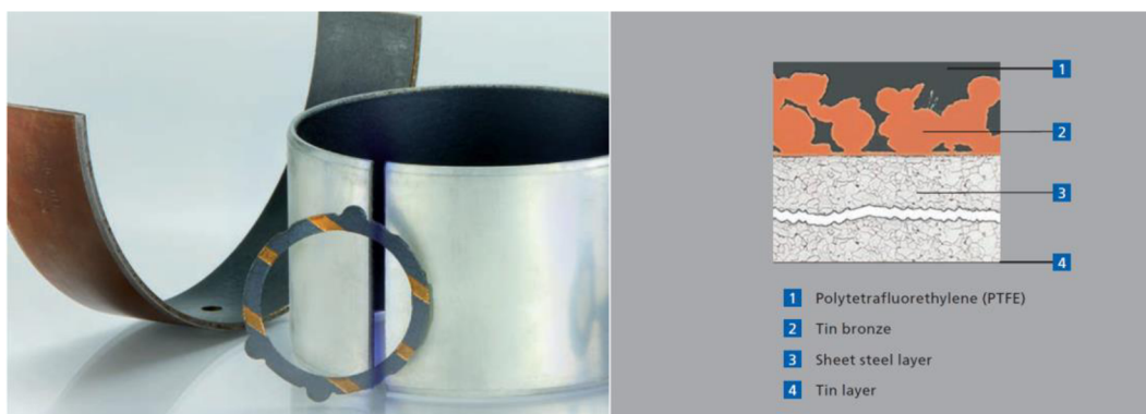
Obr. 2-12 Kovové kompozitné ložisko s PTFE klznou vrstvou typu DEVA.GLYCODUR F [7]
