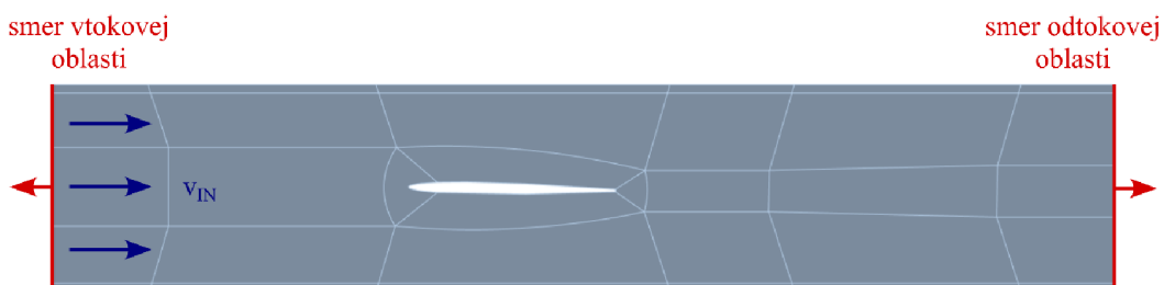
Obr. 4-4 Dekompozícia výpočtovej geometrie pre vytvorenie štrukturovanej siete
