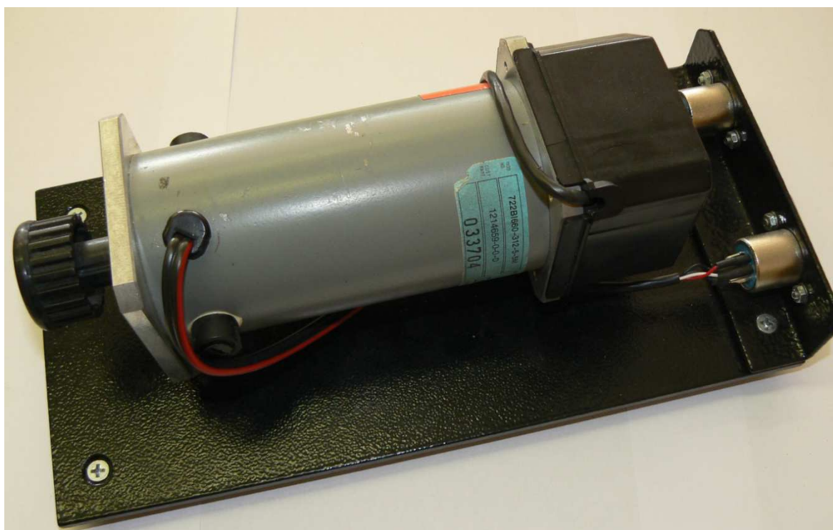
Obr.3 DC motor využitý v práci s IRC snímačem
