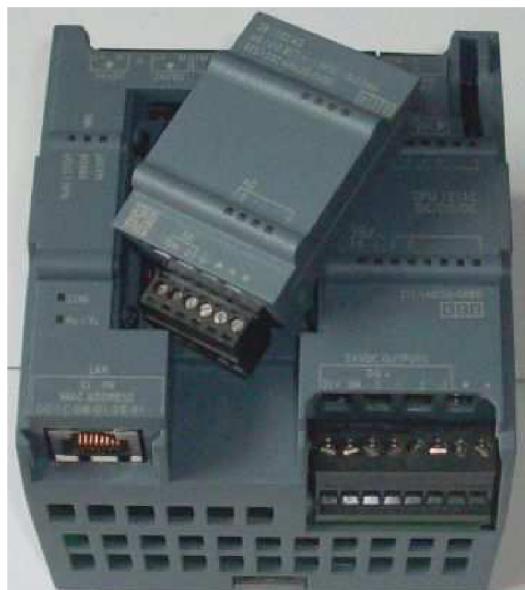
Obr.7 Vkládání signálního modulu do S7 – 1200 CPU1211C
