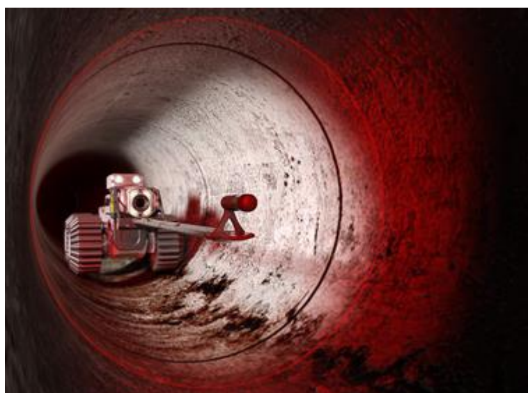
Obrázek 9: Měření ovality potrubí laserem (Envirosight, ©2020).
