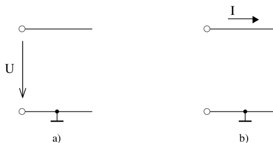
Obr. 1.3: Zjednodušené zapojení nesymetrického vedení a) napěťové b) proudové
