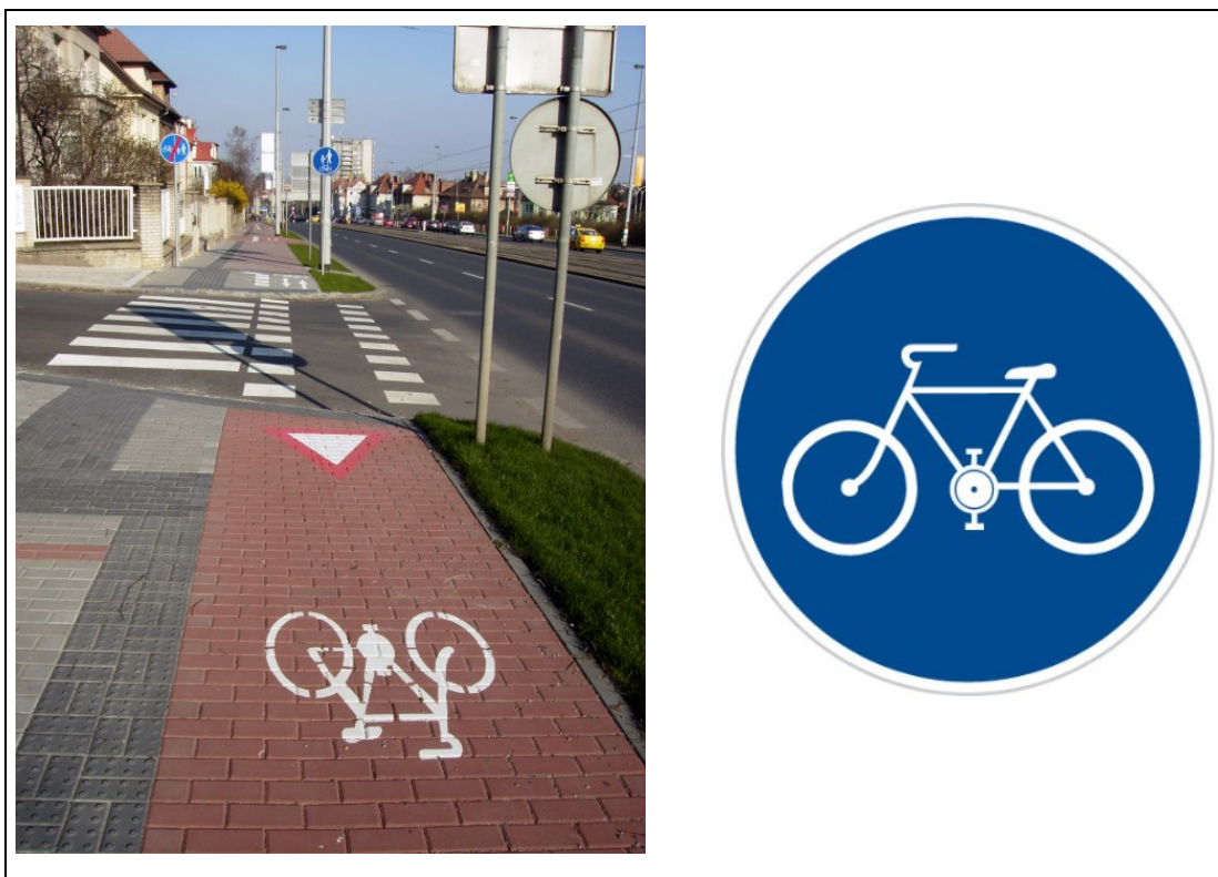
Obr. 2: Vodorné a svislé značení cyklostezek v ČR - příkazová značka C 08a - Stezka pro cyklisty (dopravní značení EU 2014)
