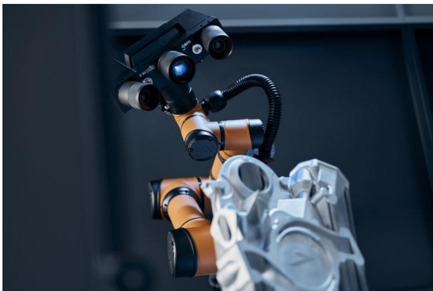
Obr. 2-2 ZEISS ScanCobot určený pro metrologickou kontrolu výrobku [6]
