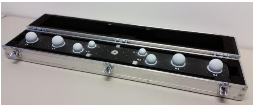
Obr. 2-6 Etalony pro kalibraci dle směrnice VDI/VDE 2634 – Part 3 [13]
