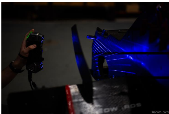
Obr. 4-5 Skener Scantech SIMSCAN během měření (autor snímku: Karel Horák, TU Brno Racing)
