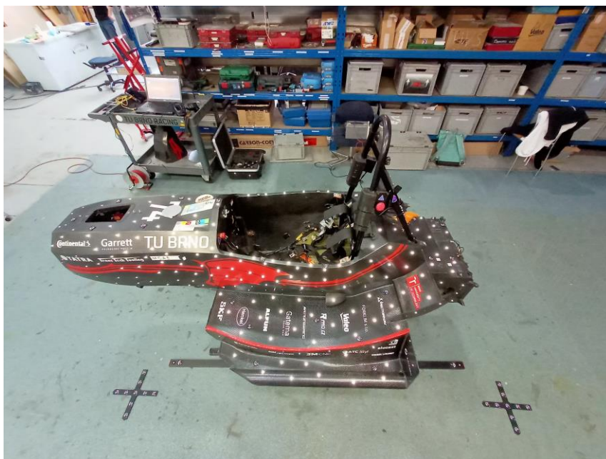
Obr. 4-2 Monokok, připravený na skenování, s rozmístěnými kalibrovanými tyčemi a kříží a polepený markery
