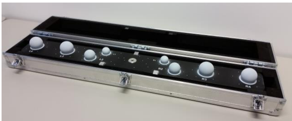
Obr. 2-6 Etalony pro kalibraci dle směrnice VDI/VDE 2634 – Part 3 [13]
