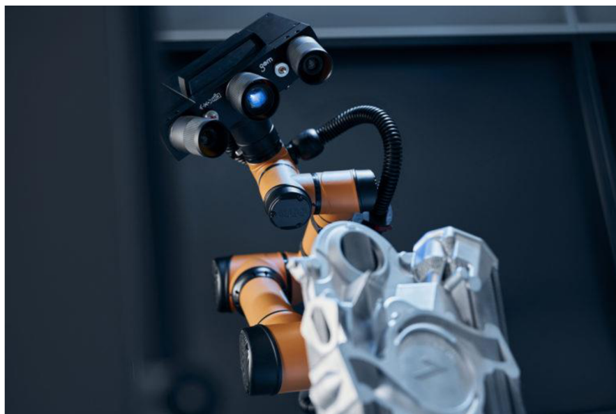
Obr. 2-2 ZEISS ScanCobot určený pro metrologickou kontrolu výrobku [6]
