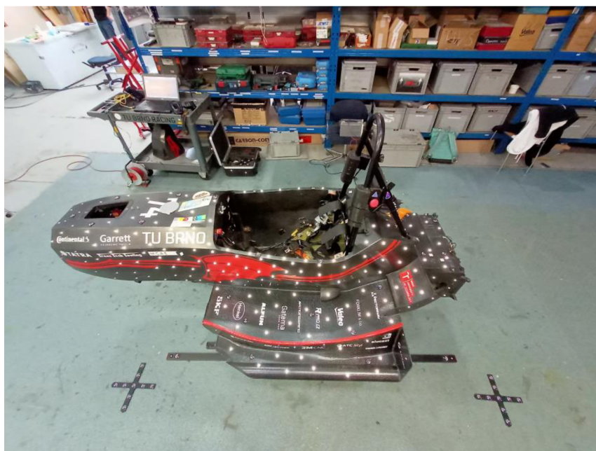
Obr. 4-2 Monokok, připravený na skenování, s rozmístěnými kalibrovanými tyčemi a kříži a polepený markery
