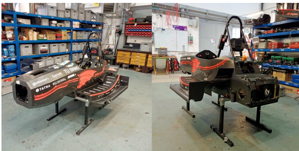
Obr. 4-1 Monokok závodního vozu TU Brno Racing
