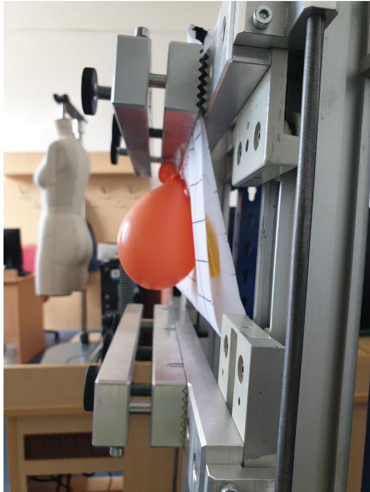
Obrázek 17 - Boční pohled na upnutý vzorek bez možnosti umístění balónku mezi vrstvy vzorku
