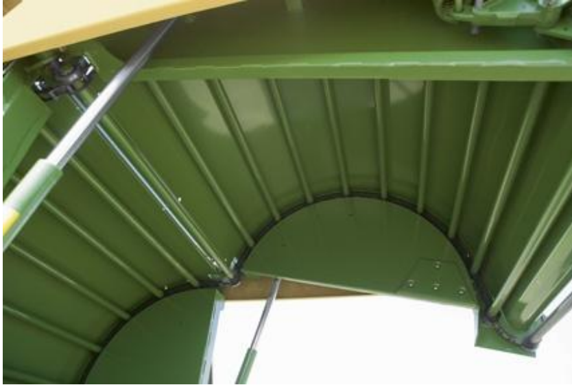
Obr. 3: Pevná lisovací komora tvořena příčkovým řetězovým dopravníkem. [5]
