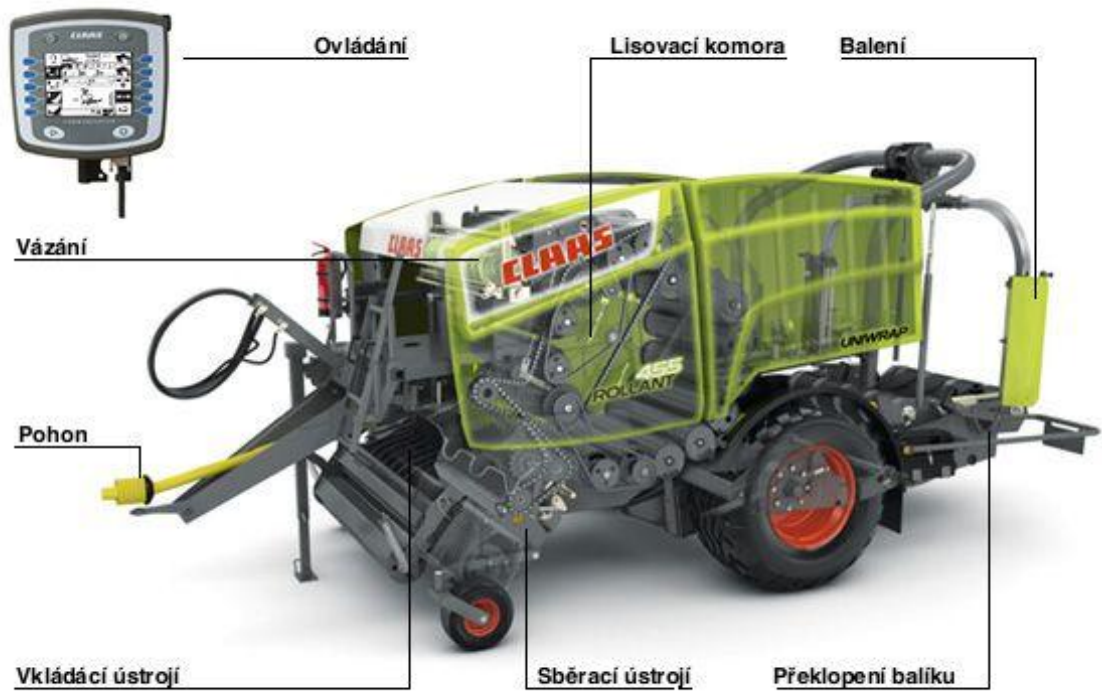
Obr. 7: Schéma lisu na válcové balíky s pevnou lisovací komorou kombinovaného s balicí jednotkou. [2]
