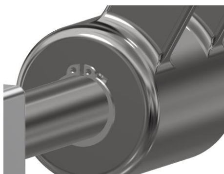
Obr. 25) Axiální zajištění spojovacího ramene na hřídeli
