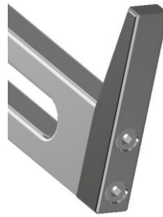
Obr. 32) Spojení úchopného prvku k jeho rameni
