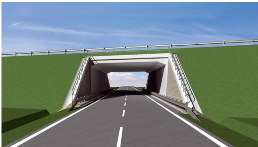
Obrázek 3 Silniční podjezd = přesypáný železniční most
