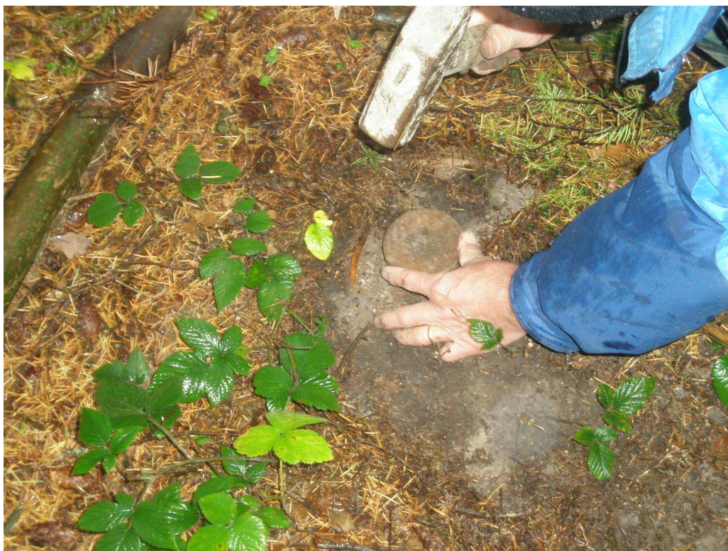
Foto č. 7: Zatloukání válečku
