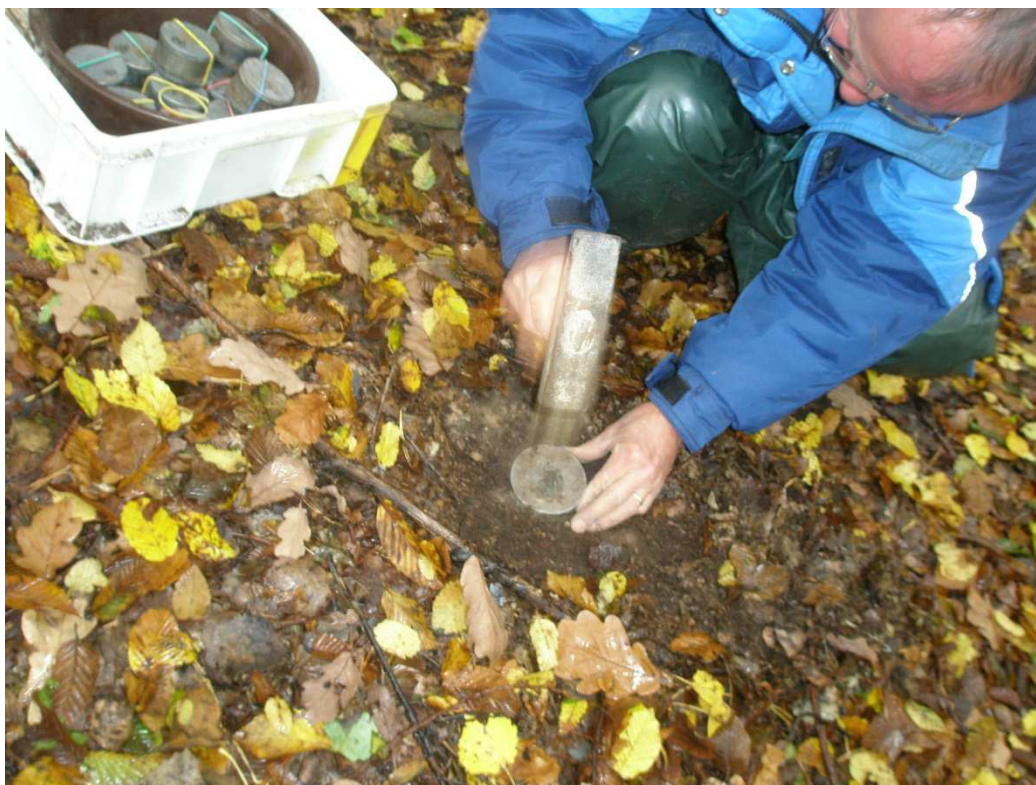
Foto č. 6: Zatloukání válečku
