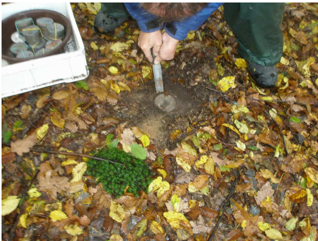
Foto č. 9: Vyjmutí válečku z půdy
