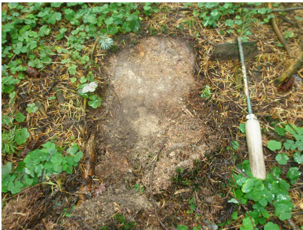
Foto č. 5: Ploška připravená k odběru
