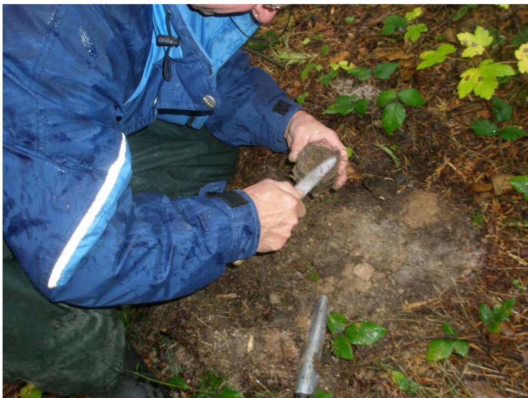
Foto č. 11: Očištění čela válečku
