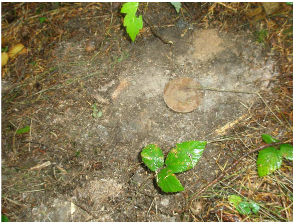
Foto č. 8: Zatlučený váleček připravený k odběru
