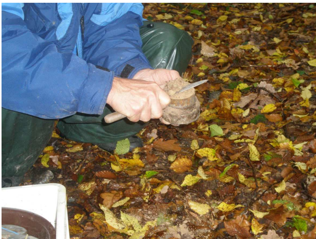
Foto č. 12: Očištění druhé strany válečku
