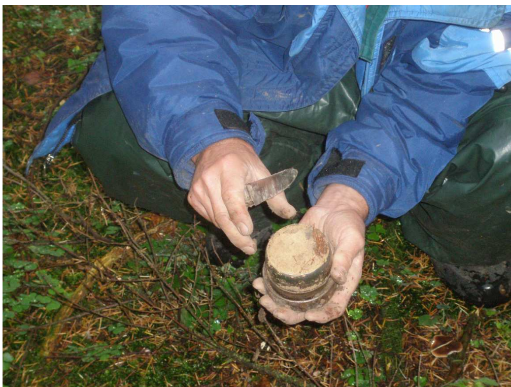
Foto č. 13: Konečná úprava válečku před uzavřením
