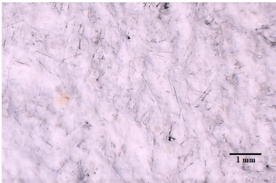
b) Sádrová omítka s 1 hm% uhlíkových vláken Obr. 55 Řez vápeno-cementovou a sádrovou omítkou
