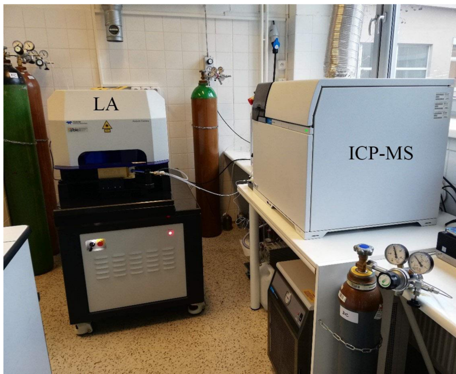
Obrázek 7: Ablací systém Analyte Excite+ (vlevo) a Agilent 7900 ICP-MS (vpravo).
