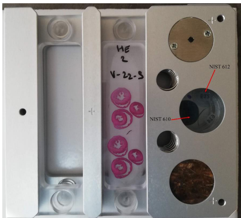
Obrázek 10: Držák laserové ablační komory se vzorky a standardními referenčními materiály
