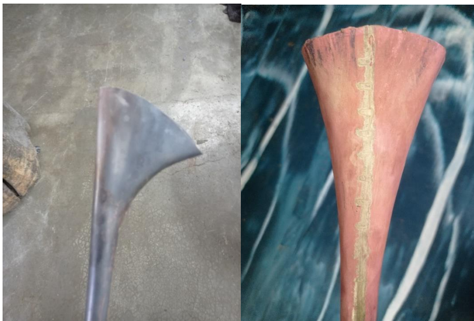
Obr. 25 – Ozvučnick před a po procesu bucharování
