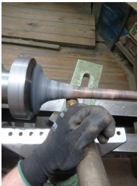
Obr. 26 – Přihlazování ozvučnicku na formu
