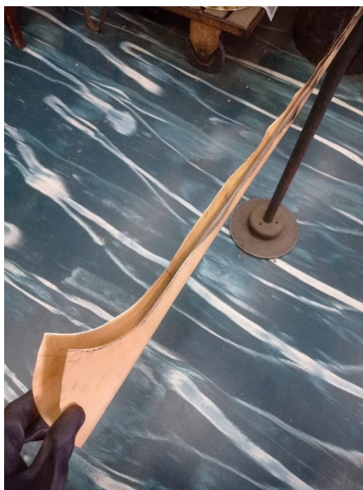
Obr. 21 – Přehnutý střih ozvučnicku připravený na skleпávání
