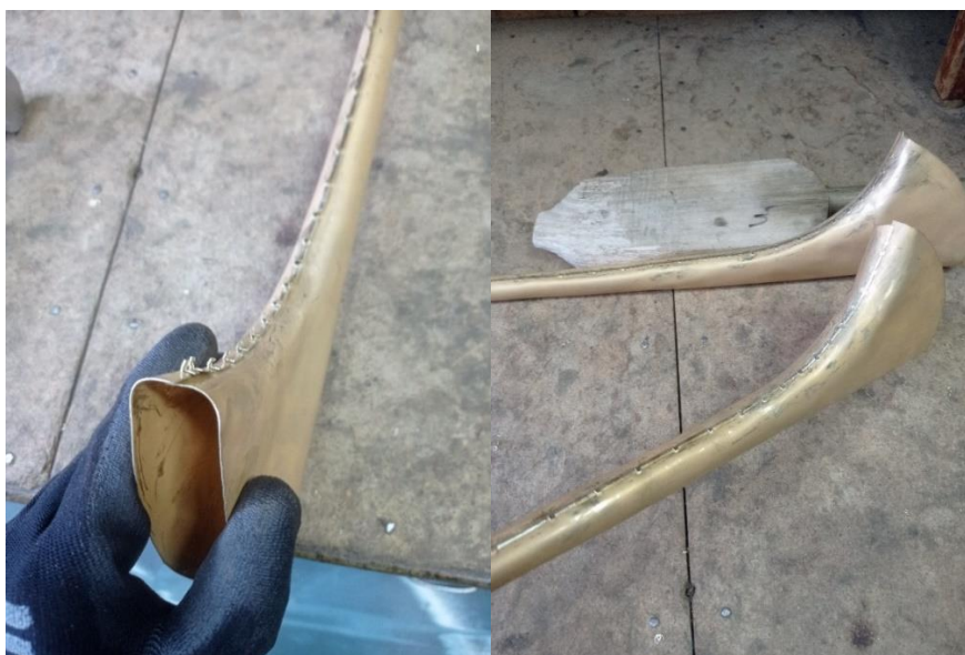
Obr. 22 – Stříh ozvučnicku před a po sklepaní ocelovým kladívkem
