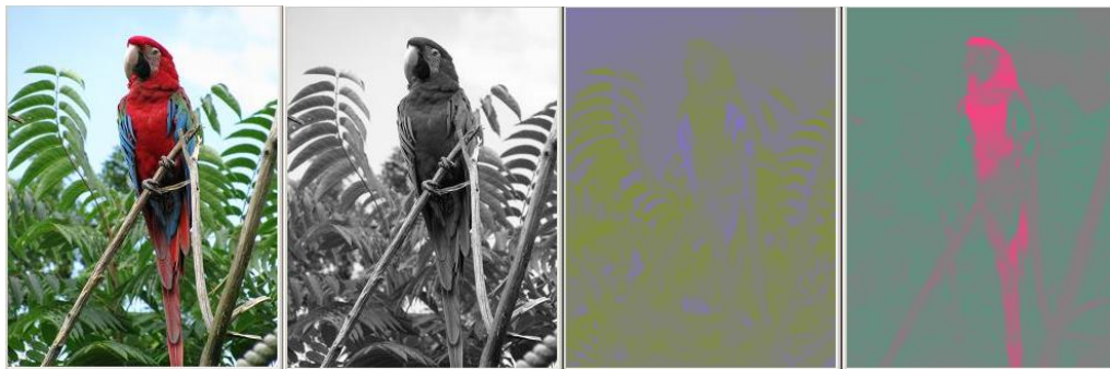
Obr. 1.2: Obrázek v RGB a jednotlivé složky modelu Y C_B C_R .
