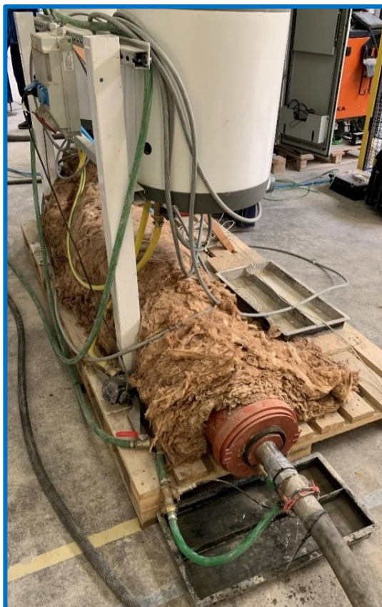
Obrázek 32 - Ohříváč proudícího betonu
