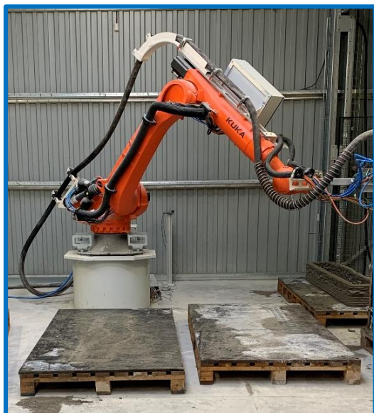
Obrázek 6 - Pracoviště pro 3D tisk betonu
