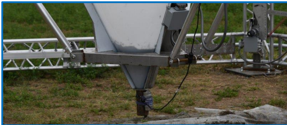
Obrázek 9 - Detail plošiny s tiskovou hlavou [46]
