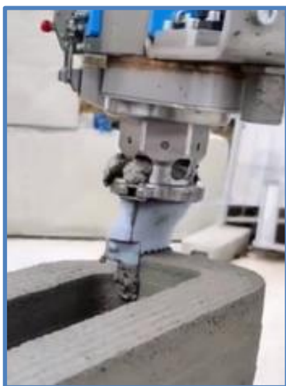
Obrázek 33 - Otočná tisková hlava s tryskou o obdélníkovém průřezu s hladítkem; upraveno dle [56]
