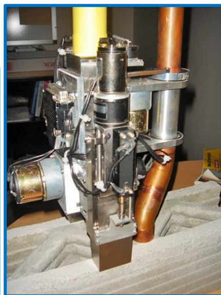
Obrázek 5 - Tisková hlava s tryskami pro metodu CC [44]
