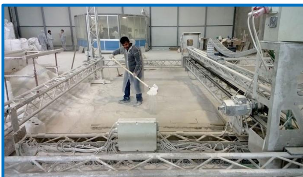
Obrázek 27 - Proces selektivního spojení pojiva [54]
