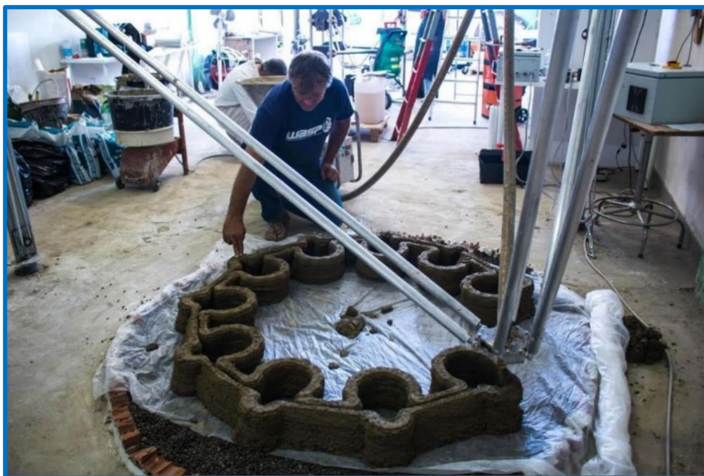
Obrázek 8 - Proces tisku na tiskárně typu Delta [45]
