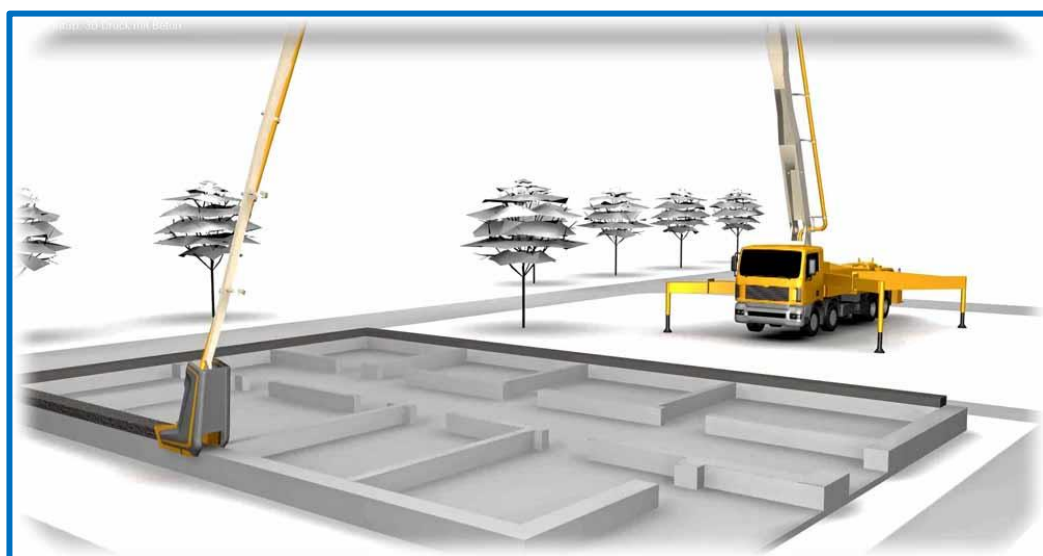
Obrázek 10 - Proces tisku u metody CONPrint [47]
