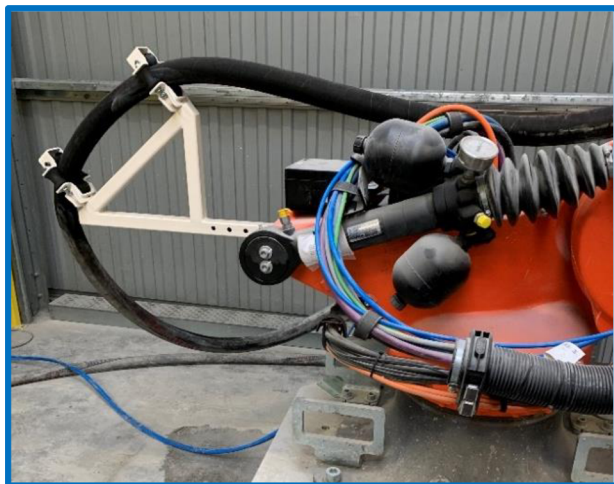
Obrázek 29 - Vedení kabelů a hadic s materiálem
