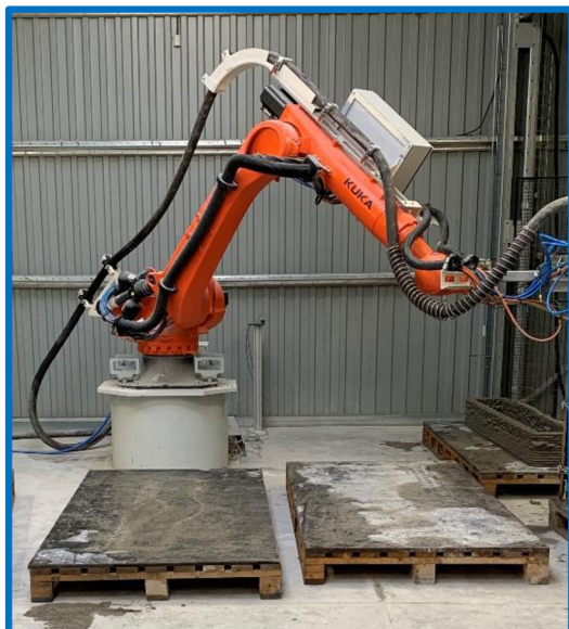
Obrázek 6 - Pracoviště pro 3D tisk betonu
