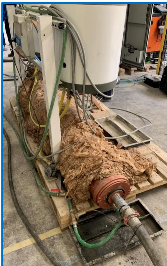
Obrázek 32 - Ohříváč proudícího betonu
