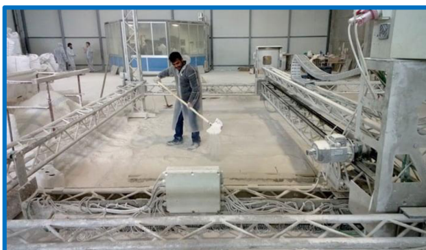
Obrázek 27 - Proces selektivního spojení pojiva [54]
