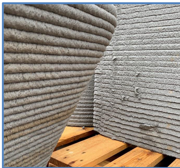
Obrázek 34 - Stěna tištěná tryskou o kruhovém průřezu (vlevo) a tryskou o obdélníkovém průřezu s hladítkem (vpravo)
