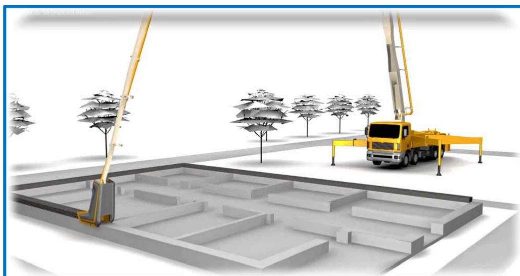
Obrázek 10 - Proces tisku u metody CONPrint [47]
