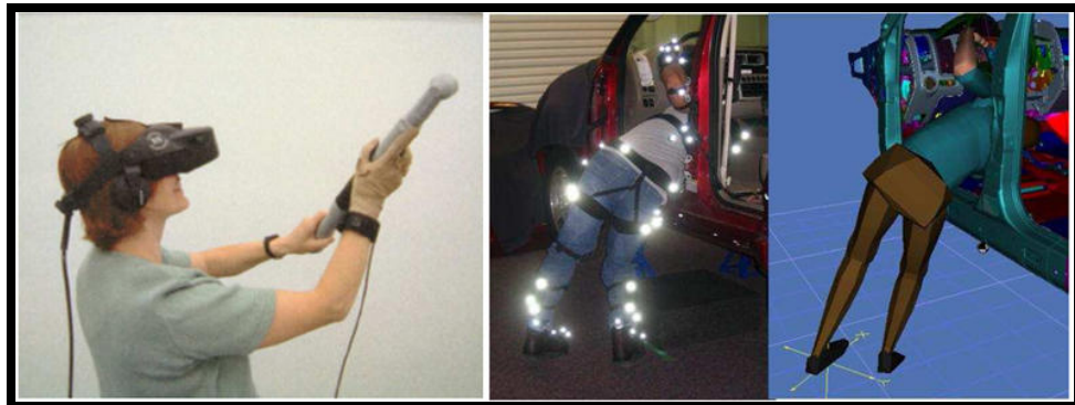
Obr. 1.17 Montáž automobilů ve virtuální realitě v Tecnomatix Jack. [14]
