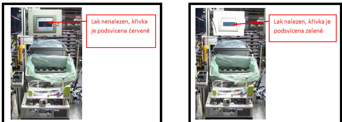
Obr. 3.7 Metoda poka-yoke a) lak nenalezen, b) lak nalezen.
