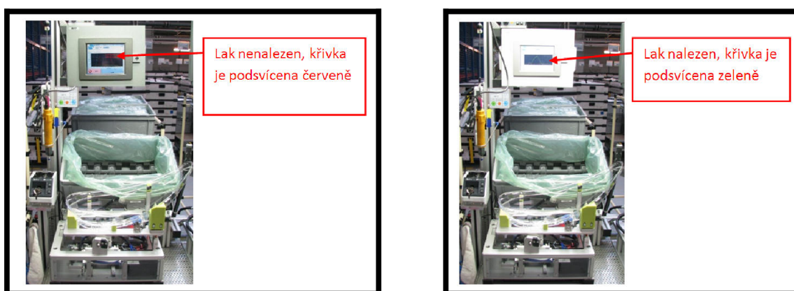
Obr. 3.7 Metoda poka-yoke a) lak nenalezen, b) lak nalezen.
