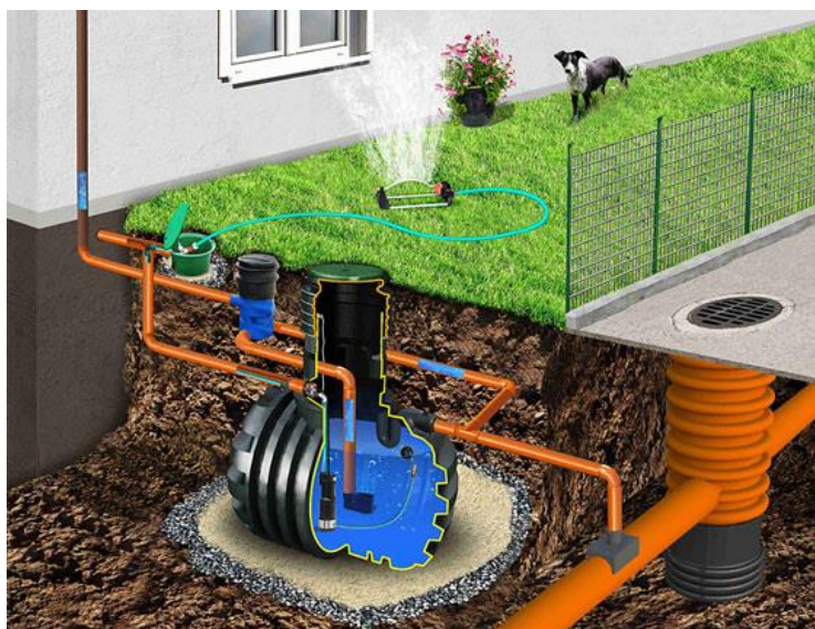
Obr. 4: Akumulační nádrž bez vsakovacího zařízení (URL 6).
